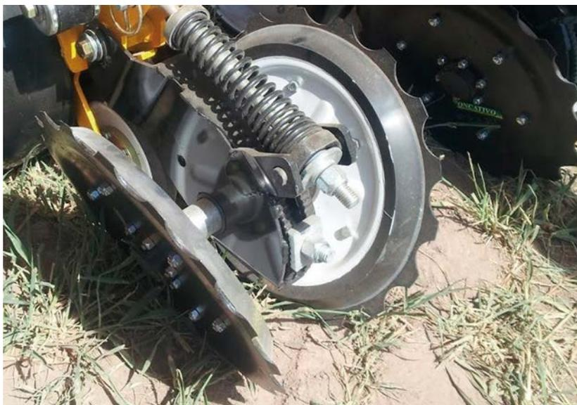
Figura 8. Ruedas tapadoras de surco con discos dentados
